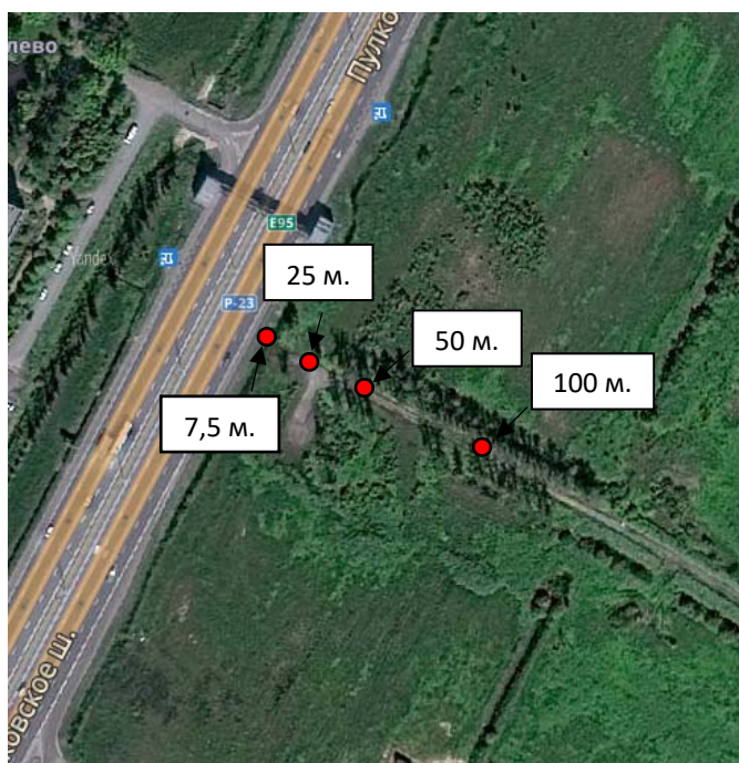
Рисунок 3.3 – Схема проведения измерений Пулковское ш.
